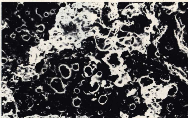
Kuva 15. Rasterielektronimikroskooppitutkimus, Degucast-U/Vita-VMK-68 perusmassakoe, tehty kontrolloidulla murtokokojestuksella, kokeessa käytettiin Deckgold normaalia väliaineena. Elektronikuva pinnasta, missä peitekultajäännöksiä ja...
