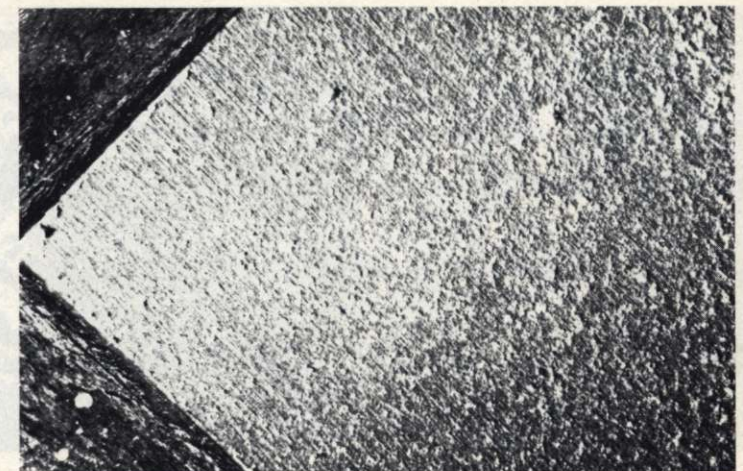
Kuva 13. Degudent-U metallisivu Vita-VMK-68 perusmassa, ilman peitekultaa, kontrolloidun murtokokeen jälkeen.
